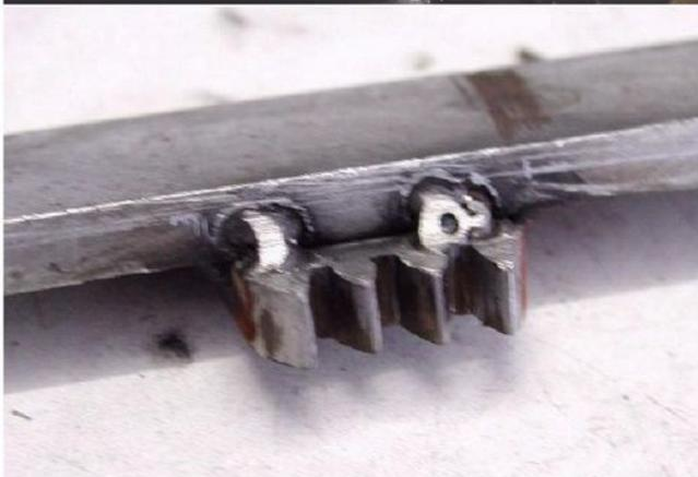
Der \* bedeutet: Anschrauben, Zahnblock ins Gehäuse einpassen, anzeichnen und dann lagerichtig anschweißen.
