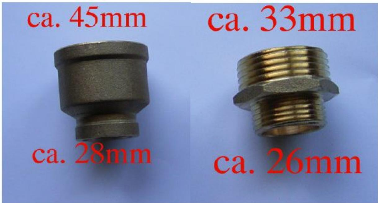
Man braucht die zwei oben gezeigten Reduzierstücke, eine lange Schraube und zwei Nüsse aus dem Knarrenkasten und schon geht's los.
