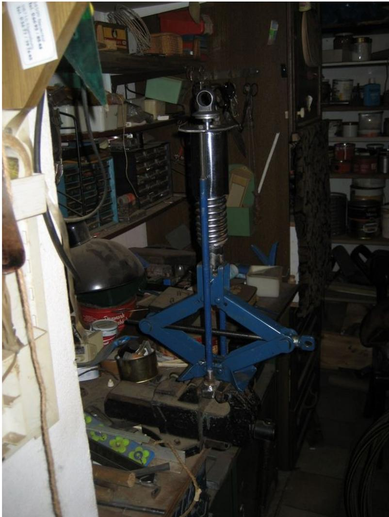
Wie man sieht, lässt sich das Gerät gut in einen Schraubstock einspannen. Dazu wurde unter den Fuß ein Eisenvierkant geschweißt. Dieser Vierkant ist auch die Basis für die Halteinrichtung für die Stangen - in diesem Fall 2 Rohre, man könnte aber auch Gewindestangen nehmen, die den „Deckel“ halten, gegen den der Stoßdämpfer gedrückt wird. Im Detail sieht das wie folgt aus:
