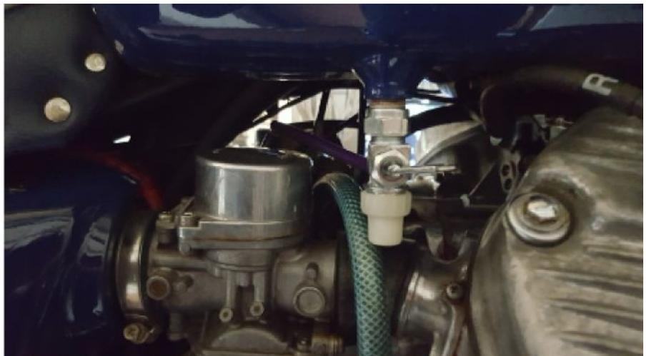
Also: für den Reinschlüssel braucht man 2(!) Hähne mit Gewinde M16 x 1,0.
