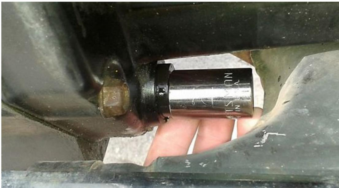
Den langen Schraubenzieher oder einen anderen geeigneten Hebel benutzen und mit Hilfe der Nuss den Simmerring passend (mit dem Gehäuse abschließend) in seinen Sitz drücken.
