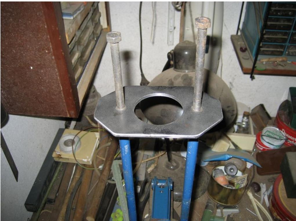
Bei der Verwendung von Gewindestangen kann man den „Deckel“ einfach mit (Flügel-)Muttern fixieren. Das untere Auge wird in die Klaue des Wagenhebers eingesetzt. Dazu wurde die Öffnung aufgeweitet und eine Bohrung durch die
