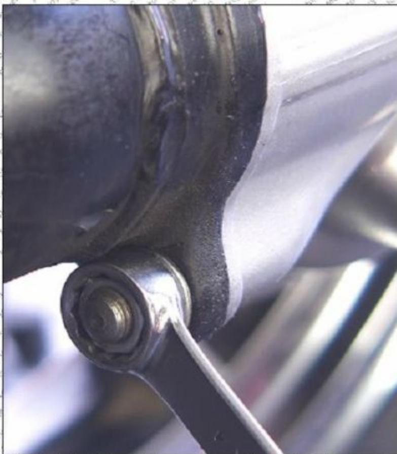
Nun die Muttern der Endantriebsbefestigung anziehen. Drehmoment nach den Werten des Handbuchs (3,5 - 4,5 kgm bzw. 35 - 45 Nm).
