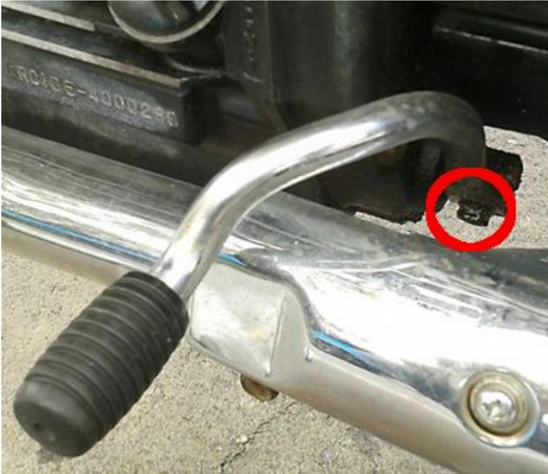
Den Schalthebel entfernen. Dazu die Schraube mit dem 10er Kopf aus der Klemmung herauserschrauben. Dafür benötigt man die Ratsche mit der 10er Nuss.
