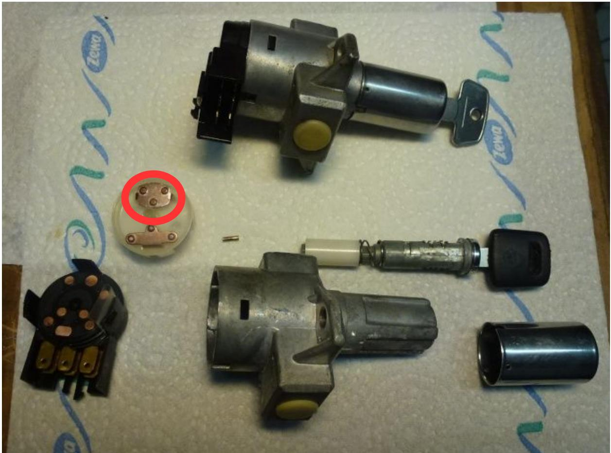
Anmerkung von mir: Man beachte die Ausrichtung der oberen Kontaktplatte ( von mir rot eingekreist) im weißen Drehteil. Weiter mit Jochens Text:
