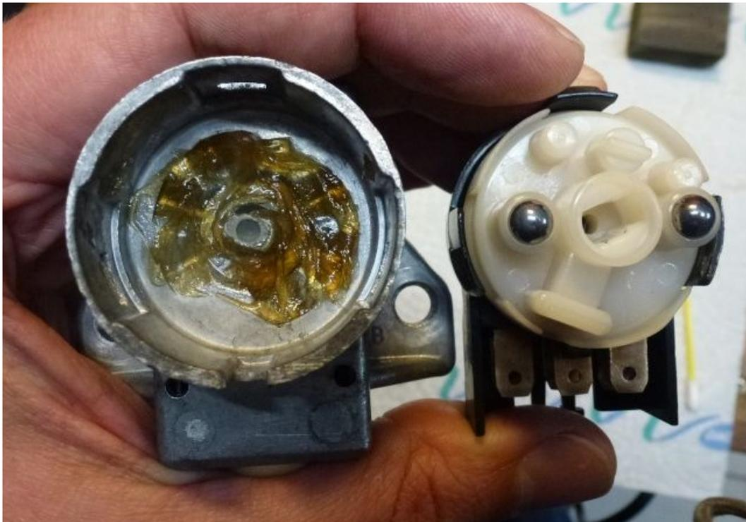
Auf Jochens Bild ist sehr gut zu erkennen, dass der untere Teil der Achse des Schließzylinders eine besondere Form hat. Damit ist ausgeschlossen, dass der Drehteller um 180° verdreht eingebaut wird.
