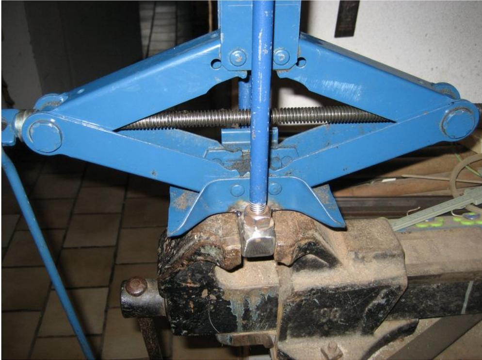
Auf den Vierkant wurden Muttern geschweißt, in die die Rohre eingedreht werden. Die Rohre haben am oberen Ende Innengewinde für die Schrauben, die den „Deckel“ halten:
