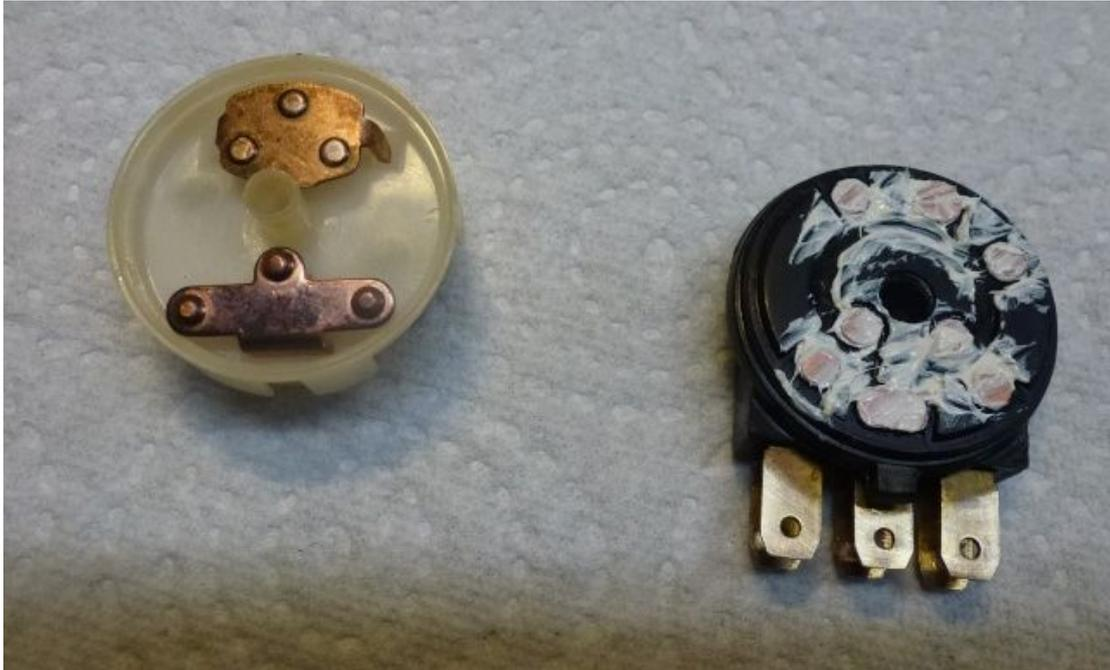
Anmerkung von mir: Man beachte die Ausrichtung der oberen kleinen Kontaktplatte im weißen Drehteller. Gegenüber dem Bild auf der vorigen Seite ist die Platte um 180° gedreht.
