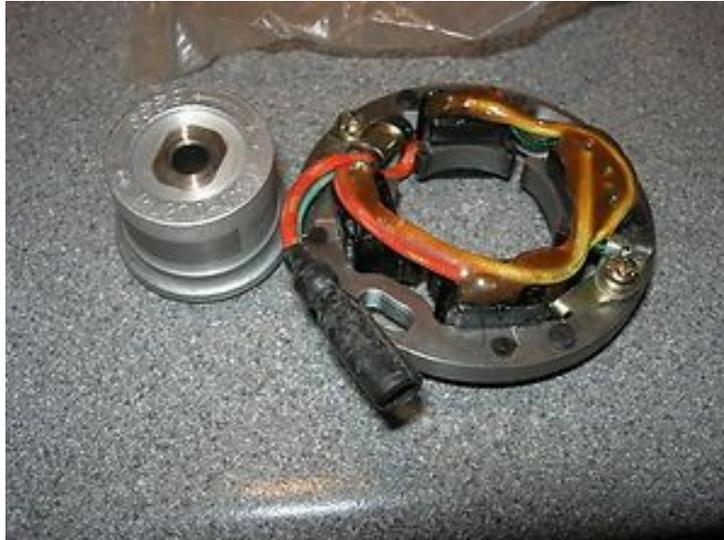
Das Massekabel kann in dem frei gewordenen Raum, in dem sich die Sensorplatine für die Frühverstellung befand, angeschlossen werden.
