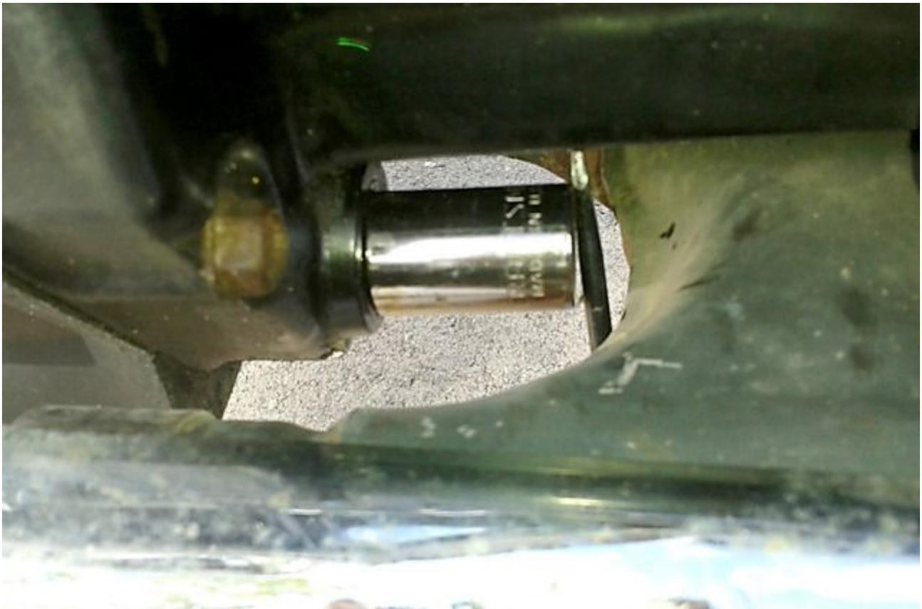
Jetzt muss der Schalthebel wieder aufgesetzt werden. Damit der in der richtigen Stellung montiert wird, hat er einen Markierungspunkt eingeschlagen.
