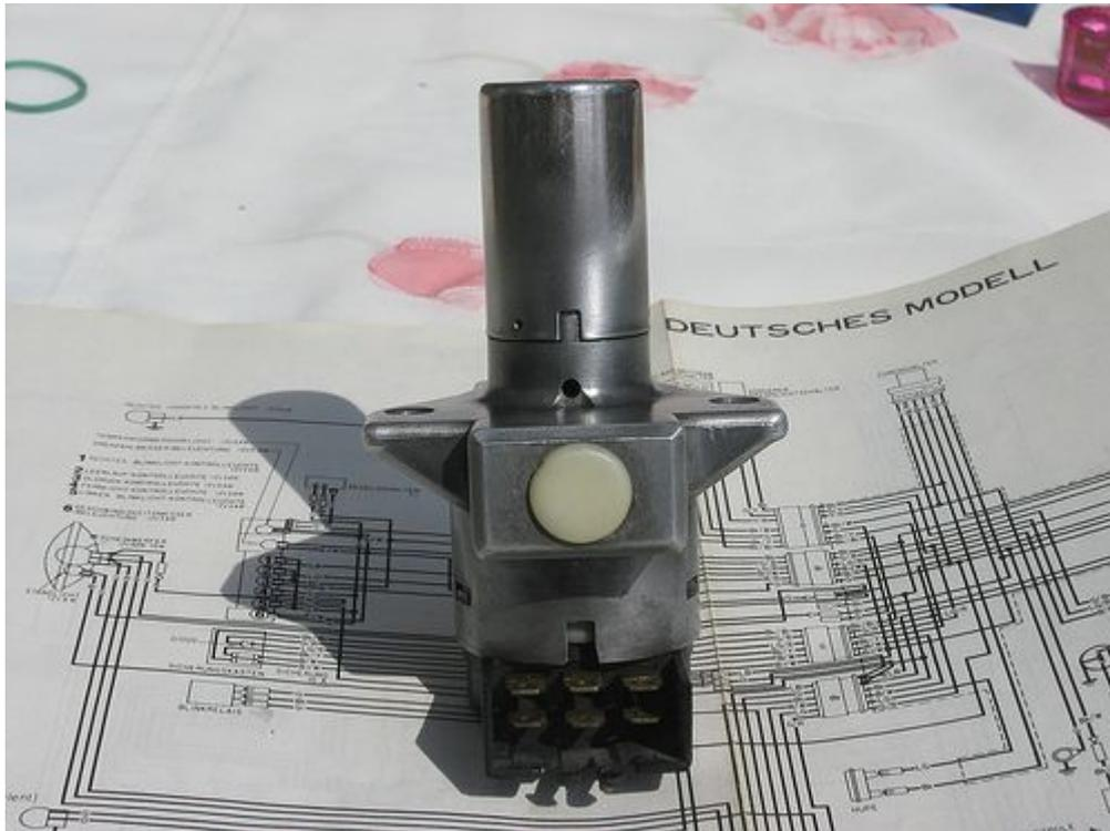
Steht das Zündschloss so vor uns (CX500 78er Modell), sehen wir die 6 Kontakte. Wir nummerieren sie durch, obere Reihe von links nach rechts 1 bis 3, untere Reihe entsprechend 4 bis 6.
