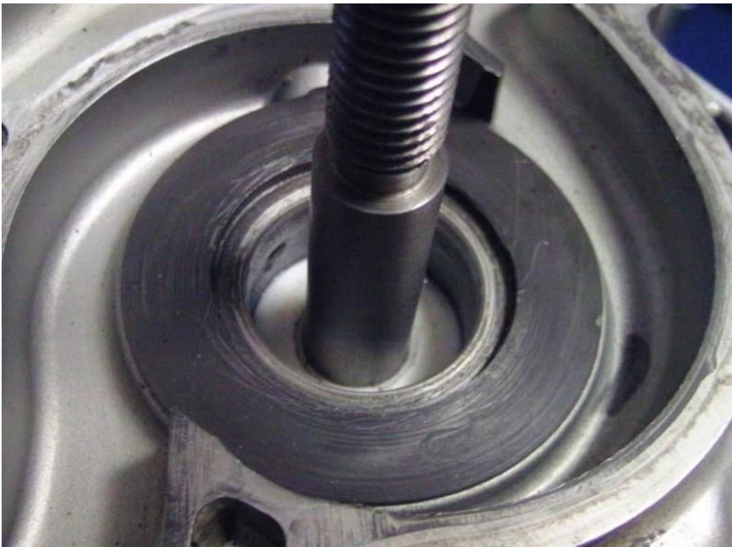
Das Werkzeug von unten(innen) in die Bohrung einschieben, bei manchen wird das saugend gehen und/oder sogar klemmen bleiben.
