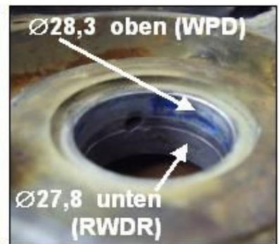
Zum Schluss des Wasserpumpenkapitels noch ein Tipp. Die mechanische Wasserpumpendichtung der XZ550 Yamaha passt auch an der CX500 und ist erheblich billiger.
