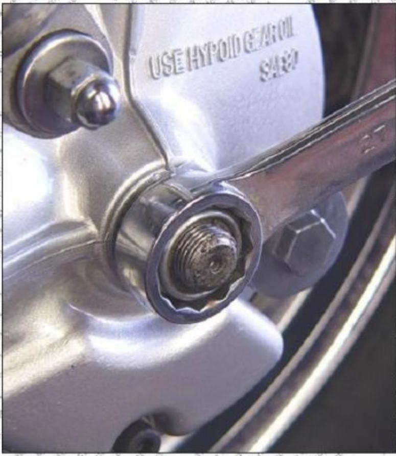
Die Achsmutter aufschrauben und mit dem nach Handbuch vorgeschriebenen Wert (5,5 – 6,5 kgm bzw. 55 – 65 Nm) festziehen und den Sicherungssplint anbringen, wenn erforderlich. (Diese V 65 Magna hat statt eines Sicherungssplints eine selbstsichernde Mutter.)
