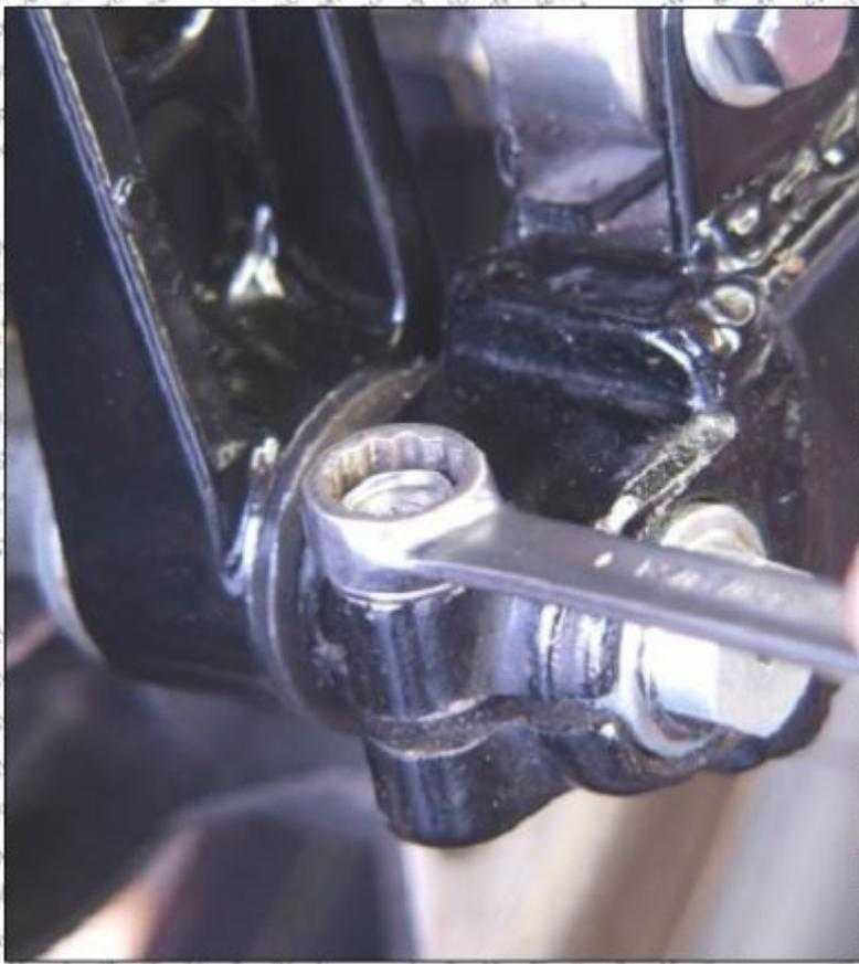
Zum Schluss die Achsklemmung festziehen. Drehmoment wieder nach Handbuch (2,0 – 3,0 kgm bzw. 20 – 30 Nm).
