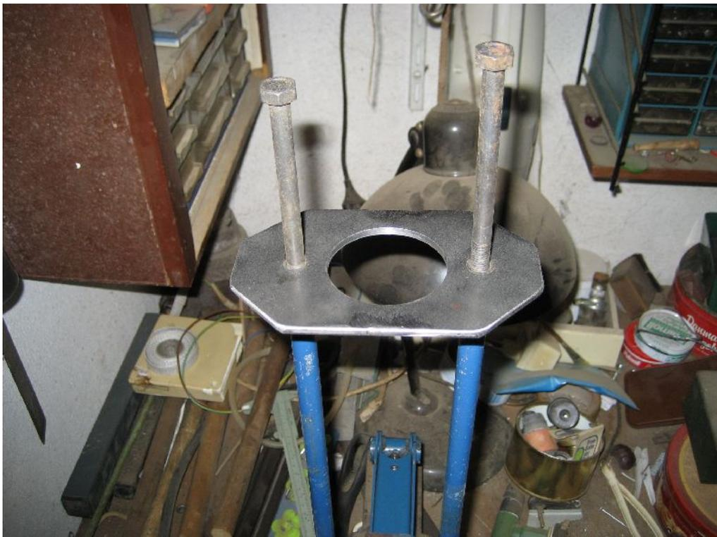
Bei der Verwendung von Gewindestangen kann man den „Deckel“ einfach mit Muttern fixieren. Das untere Auge wird in die Klaue des Wagenhebers eingesetzt. Dazu wurde die Öffnung aufgeweitet und eine Bohrung durch die beiden Wangen geführt, die den Stift für die Fixierung des unteren Auges aufnimmt. Zu dem Stift kommt noch eine Hülse, die dem Durchmesser des Auges entspricht.
