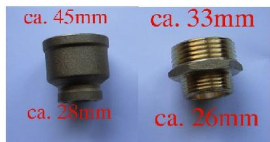
Man braucht zwei Reduzierstücke, eine lange Schraube und zwei Nüsse aus dem Knarrenkasten und schon geht's los.
